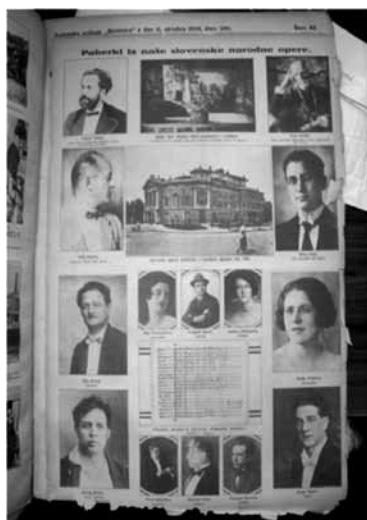
Sliki 18 in 19: Ilustrirani Slovenec: primer hujše obrabe gradiva, drobljenje gradiva, tudi zaradi previsoke temperature s presuhim ozračjem
